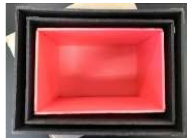
図3 発泡ポリエチレンで作成した囲い
