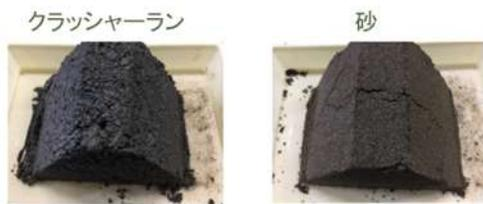
〔結果〕砂はクラッシャーランより強いため、以後の実験では砂を用いることとする。
