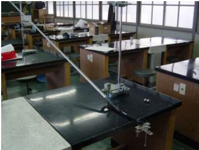
③ ①、②の工夫をほどこした装置を水平な台にセットして、床に模造紙とカーボン用紙を置いて、球の着地点がわかるようにする
