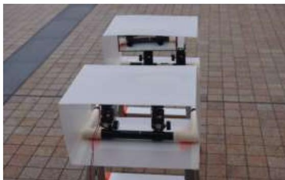
図6 プラ段ボール製カバー
