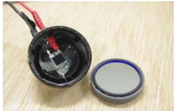
図2 バンドパスフィルタ（φ20mm）とフォトダイオード（5mm 角）
