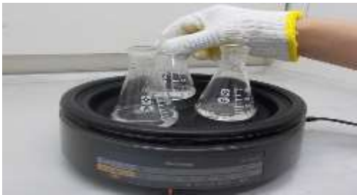
写真-2 実験Ⅱにおけるマンガンの酸化の様子
