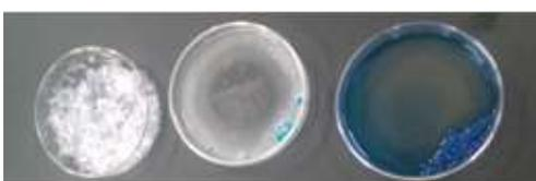
図13 アルギン酸カルシウムそのまま・アルギン酸カルシウム+シュウ酸鉄(Ⅲ)水溶液・アルギン酸カルシウム+フェーリング液
