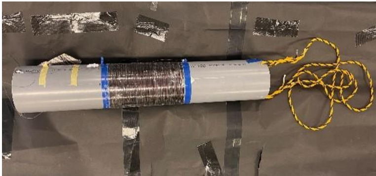
（写真 5）海での使用する塩ビパイプに巻き付けたコイル
