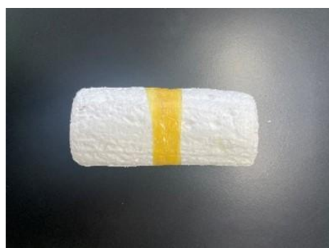
(写真 1) 筒にエナメル線を 500 回巻いたコイル (写真 2) 円柱発泡スチロールに磁石を入れた浮き
