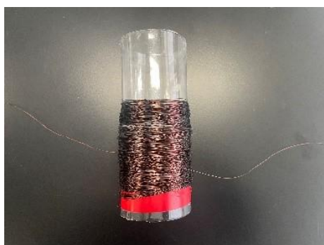
(写真 1) 筒にエナメル線を 500 回巻いたコイル (写真 2) 円柱発泡スチロールに磁石を入れた浮き
