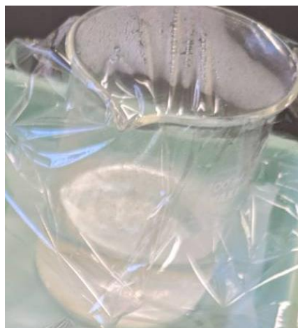
写真 2 : 30%過酸化水素水で処理した後の状態 すべて脱色されている
