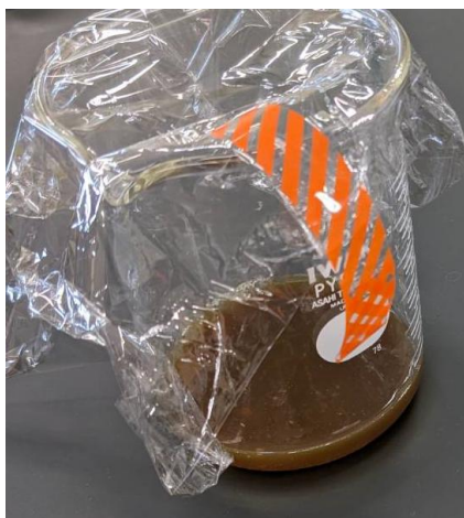
写真 1 ; 10%水酸化カリウム溶液で処理した後の状態
