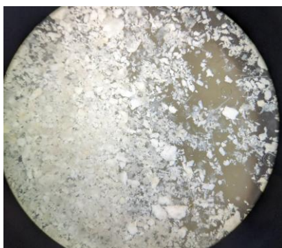
写真 3 : 30%過酸化水素水処理後、濾物の双眼実体顕微鏡での検鏡像
