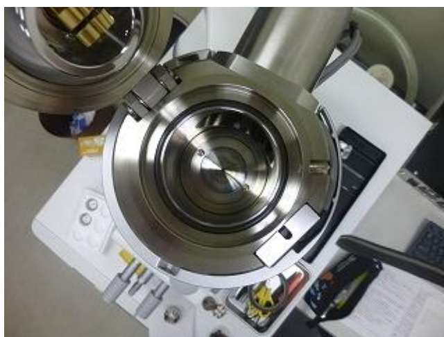
〔図5〕 電子顕微鏡の内部で、上部のフィラメントから電子線が照射される
