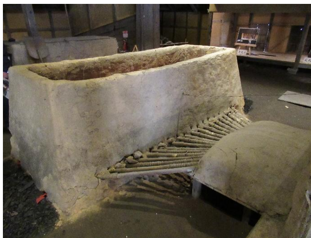
〔図 2〕 土で固めたたたら場
